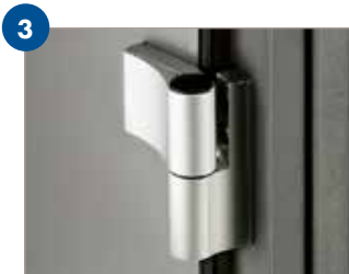
BÄNDER (3 STÜCK) 1) Aufliegende zweiteilige Türbänder, dreidimensional verstellbar, in EV1, Tragkraft bis 160 kg Flügelgewicht pro Band
